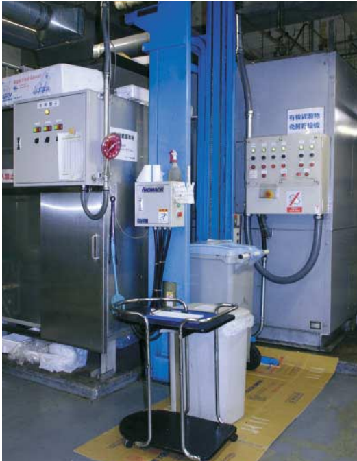
生ゴミを肥料の原料へと再生する発酵乾燥機。原料は石狩の肥料メーカーが製品化。実際に農家などで使われている。
