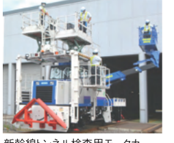
新幹線トンネル検査用モーターカー
